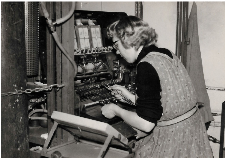
Meine Mutter Steffi Viczen in der Elektrovag beim Radioröhren mit Quecksilber bedampfen
